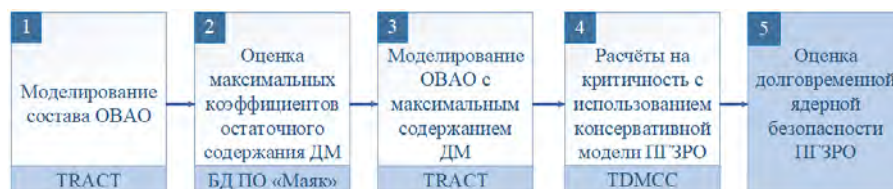
Рис. 1. Схема оценки долговременной ядерной безопасности ПГЗРО
