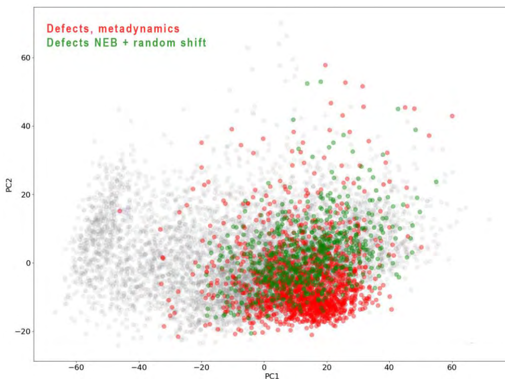
Рис. 2. Представление обучающей выборки по методу главных компонент в пространстве дескрипторов. Конфигурации с мигрирующим дефектом полученные двумя методами: метадинамикой и смещением атомов из метода упругой ленты.
