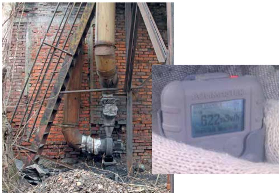
*Основной источник радиации, мотор и его улитка*
