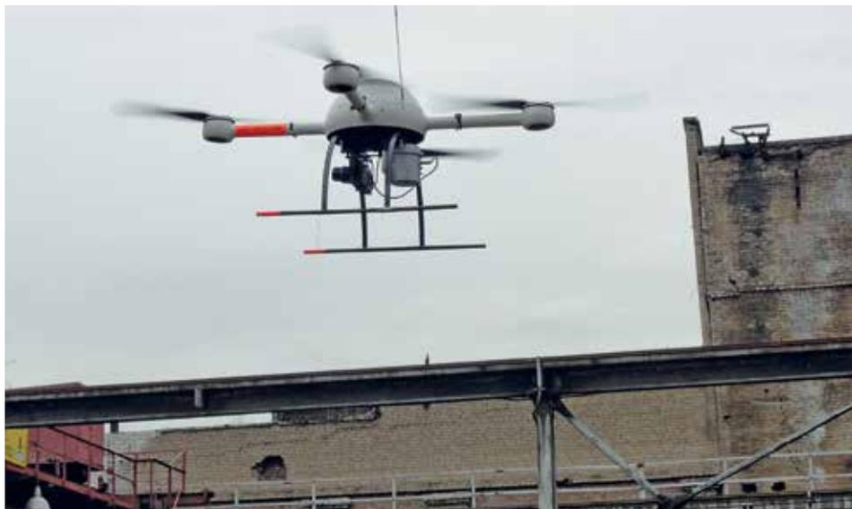
*Аэрогаммасъемка с помощью БПЛА*
