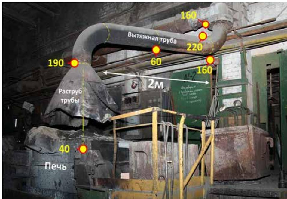
*Измеренная мощность дозы внутри аварийного цеха цветного литья достигала 220 мЗв/ч*
