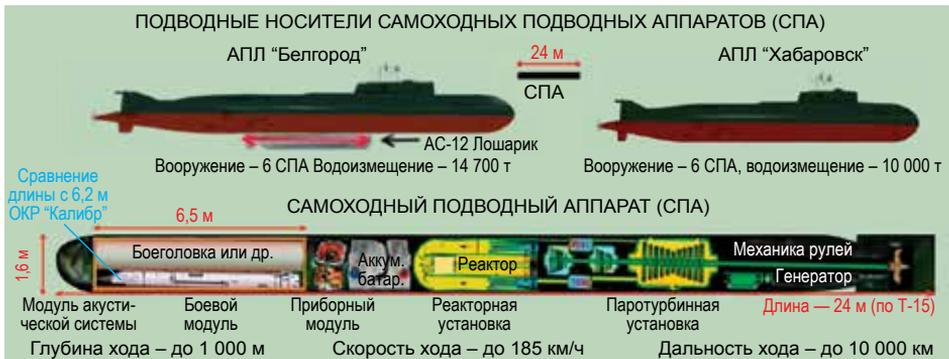
*Беспилотная ядерная торпеда «Посейдон». «Торпеда апокалипсиса», способная пересечь любой океан, перевозится специальной подводной лодкой. Может развивать скорость до 70 узлов. Эта скорость выше, чем у подводных лодок США и их противокорабельных торпед*
