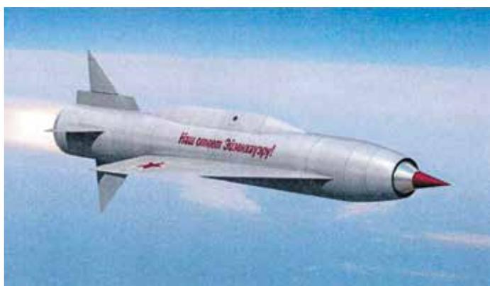
*Предшественник «Буревестника» — межконтинентальная крылатая ракета «Буря». Разрабатывалась в СССР в разных модификациях, в том числе с ядерным прямоточным воздушным двигателем, с 1954 по 1975 годы*
