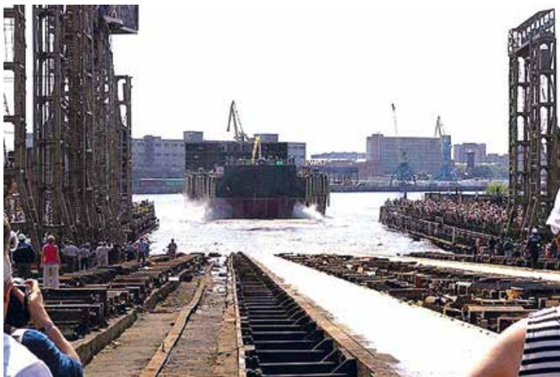
Рис. 2. Спуск на воду плавучего энергоблока «Академик Ломоносов» проекта 20870
