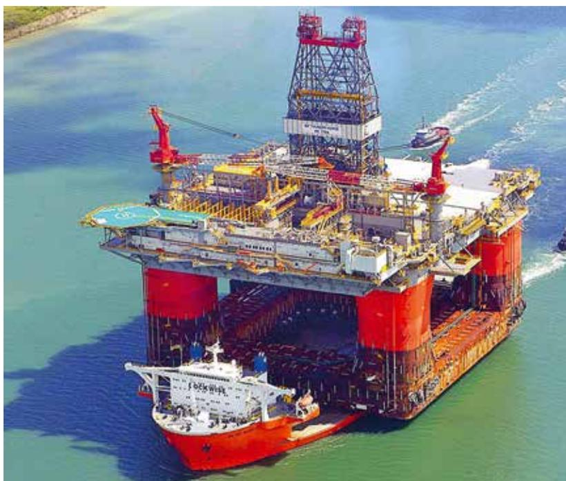
Рис. 3. Транспортировка морской платформы на судне-доке типа «Траншельф»
