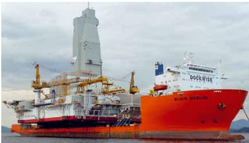
Рис. 6. Крупнотоннажный морской транспортировщик «Dockwise»
