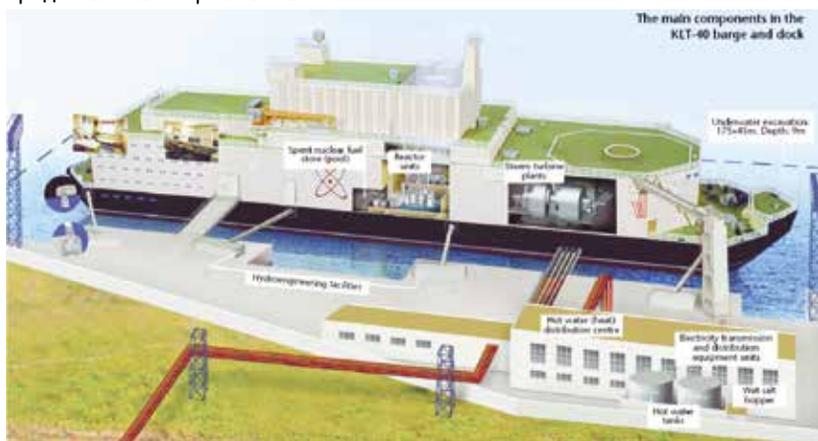
Рис. 1. Общий вид плавучей АЭС с двумя реакторами КЛТ-40 («Росэнергоатом», Россия) [2]
