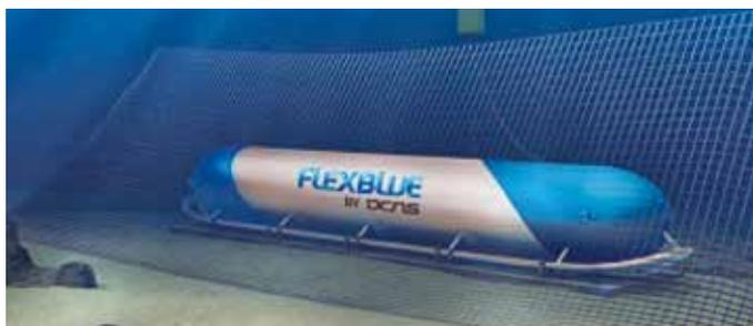
Рис. 2. Модуль АЭС «Flexblue», базирующийся на морском дне, в рабочем положении на дне моря (компания DCNS, Франция) [2]
