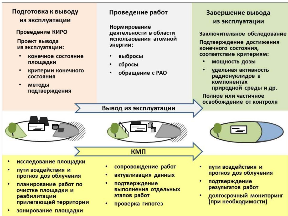
Рисунок 22. Иллюстрация возможного использования КМП при выводе из эксплуатации
