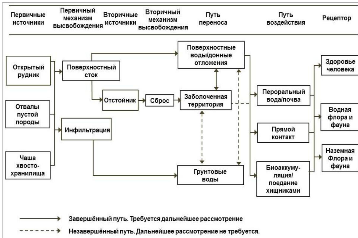
Рисунок 20. Уточнённая КМП с указанием завершённых и незавершенных путей воздействия для грунтовых вод [46]
