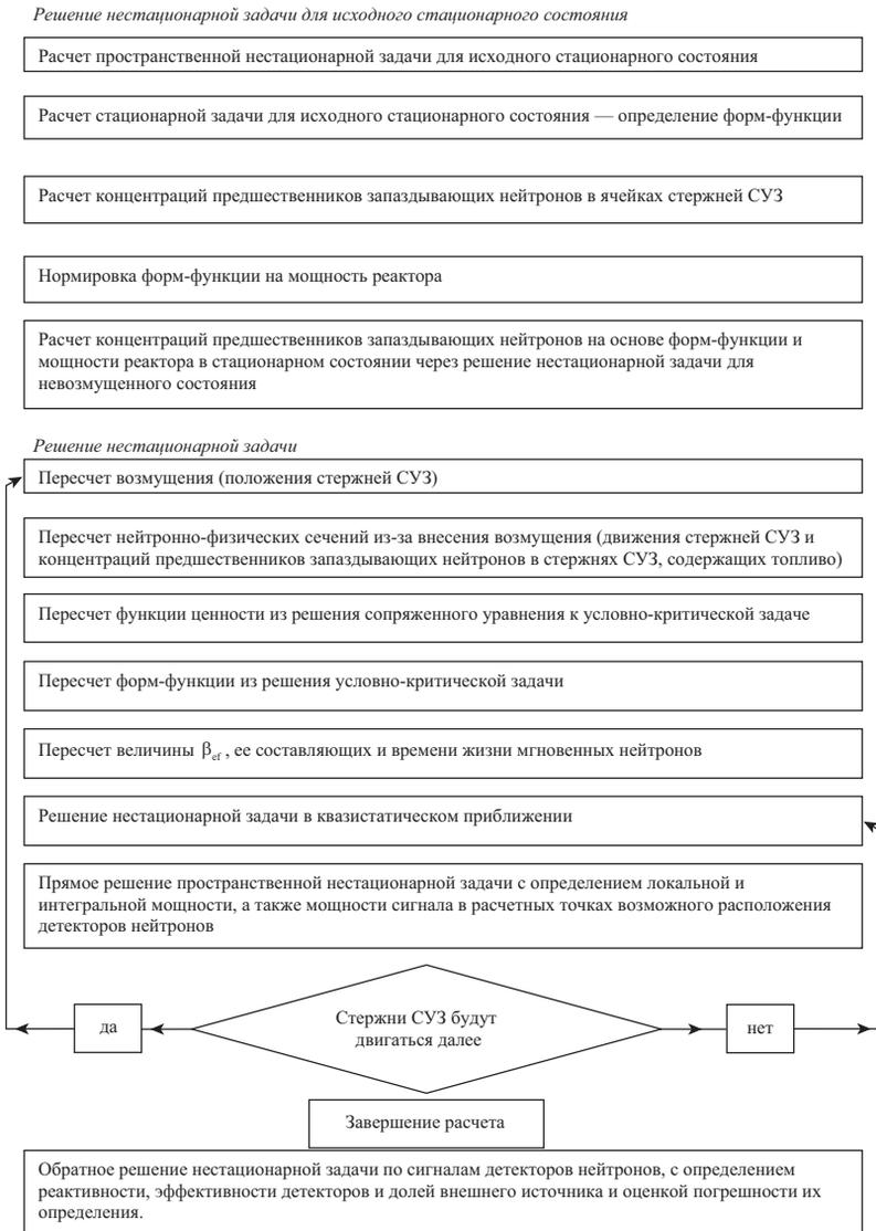
Рис. 6.2. Схема работы модуля TIMER
